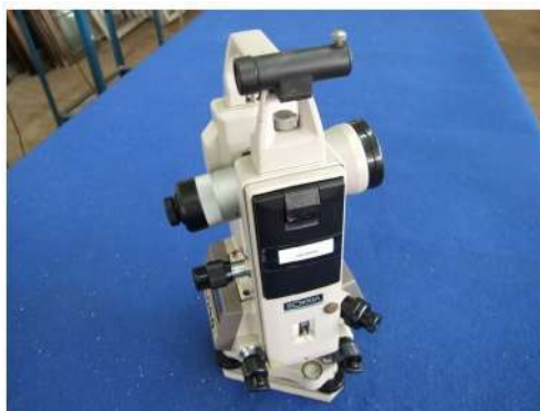
รูปภาพที่ ๒๐ แสดงกล้องวัดมุมระบบอิเล็กทรอนิกส์ ที่มา: นายชาติชาย ฉัตรทอง. (๒๕๖๓).
